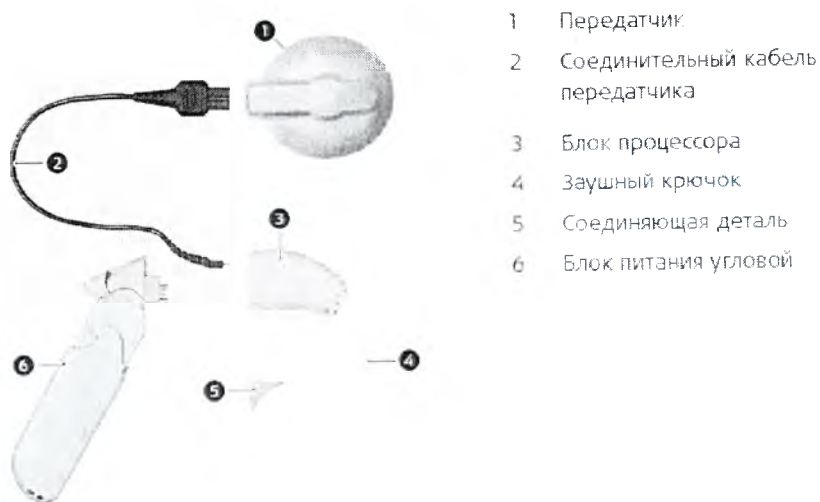
Рис. 5-в Речевой процессор OPUS 2
