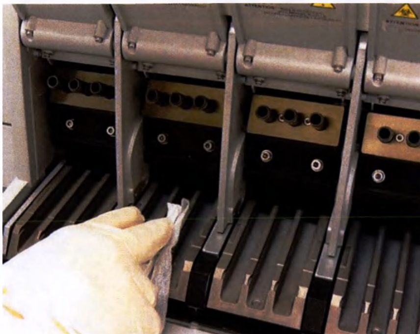
Рис. 12-10: Очистка слотов стрипов
