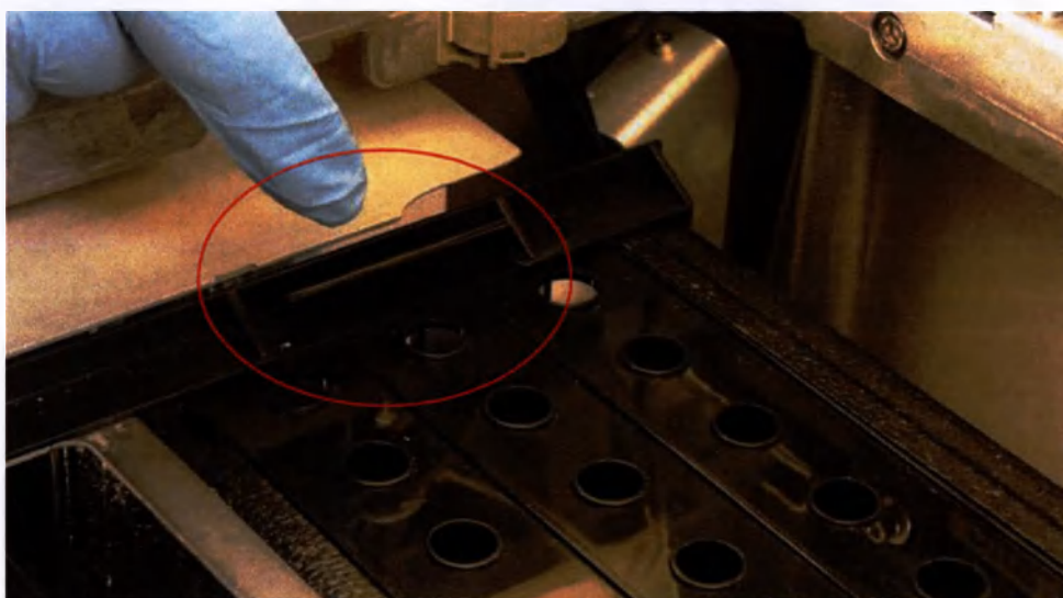
Рис. 12-17: Блокировка крышки загрузочного отсека
