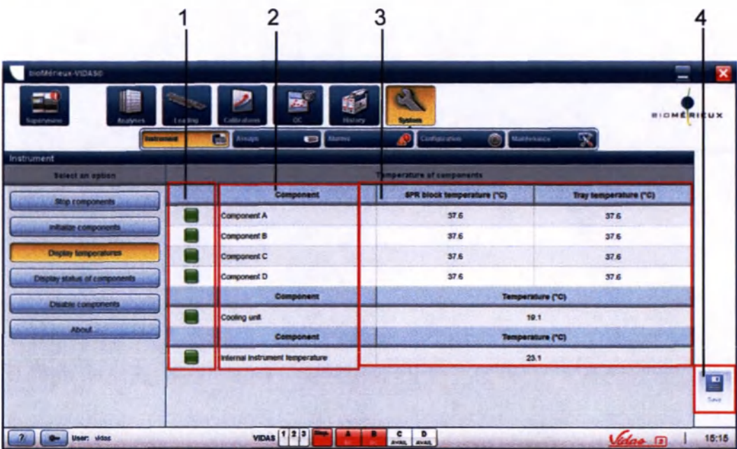
Рис. 11-5: Область Temperature of components (Температура компонентов)
