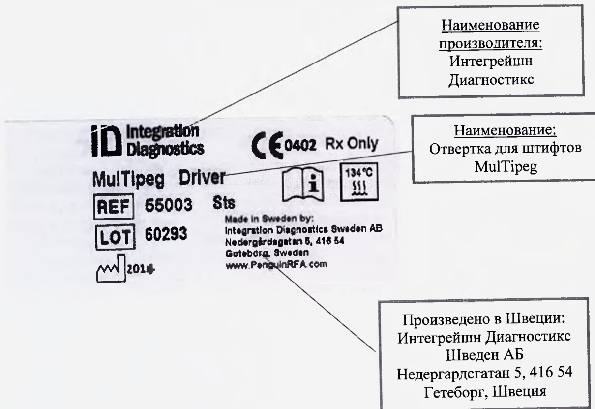
Рис. 10 Пример маркировки отвертки для штифтов MulTipeg
