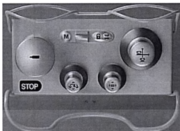
Устройство Smart Box стола Innova ® (конфигурация OR)
