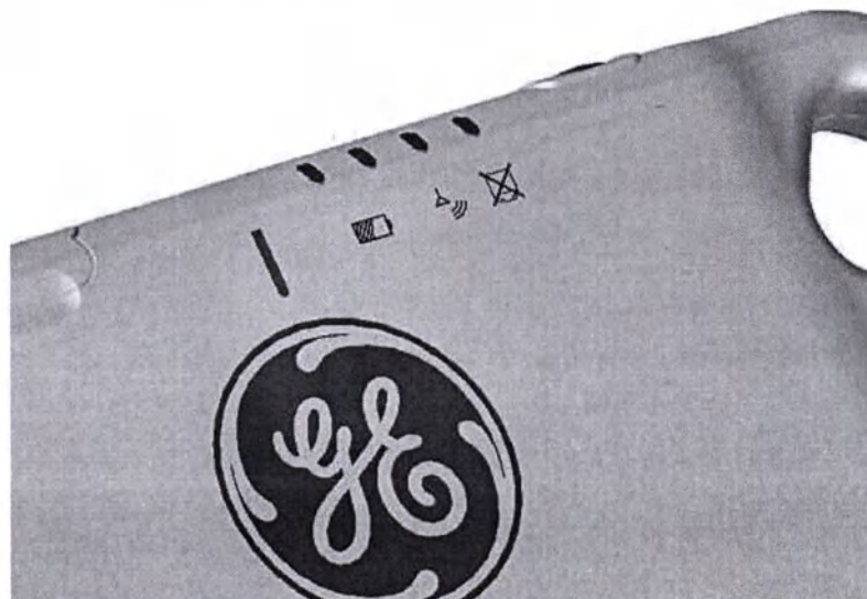
Рис. 13-18 Детектор выключен (в спящем режиме)
