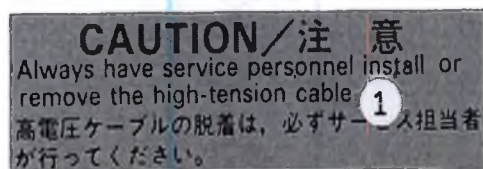
Рис. 2-14 Предупреждающая табличка для рентгеновской трубки (кабель)
