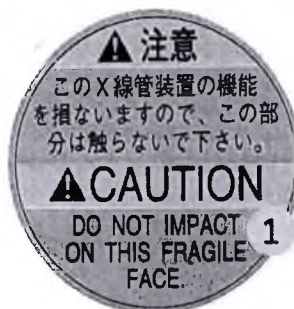
Рис. 2-17 Предупреждающая табличка для рентгеновской трубки (хрупкая поверхность)
