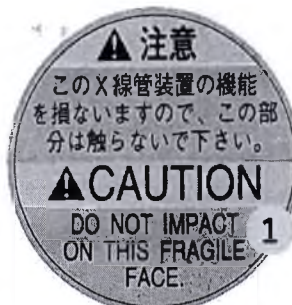
Рис. 2-17 Предупреждающая табличка для рентгеновской трубки (хрупкая поверхность)
