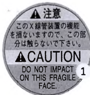
Рис. 2-16 Предупреждающая табличка для рентгеновской трубки (хрупкая поверхность)
