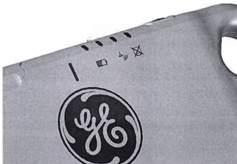
Рис. 13-18 Детектор выключен (в спящем режиме)
