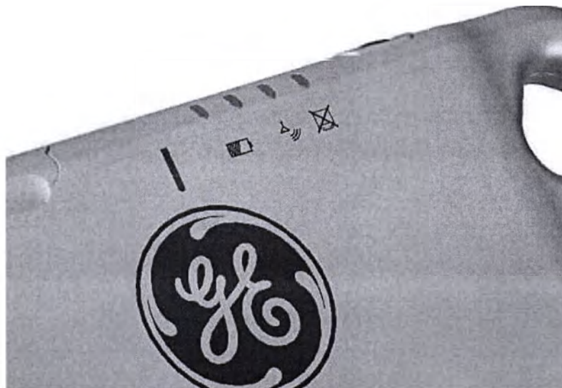
Рис. 13-14 Осталось 25—75% заряда батареи; беспроводная связь подключена; детектор готов к работе
