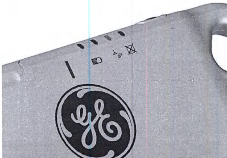
Рис. 13-16 Осталось менее 10% заряда батареи; беспроводная связь подключена; экспозиция детектора не разрешена
