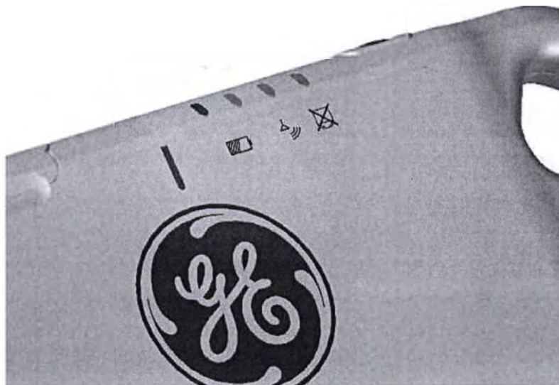
Рис. 13-14 Осталось 25—75% заряда батареи; беспроводная связь подключена; детектор готов к работе
