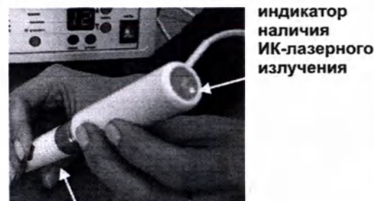
Рис.11. Проверка работы одиночного ИК-лазерного излучателя
