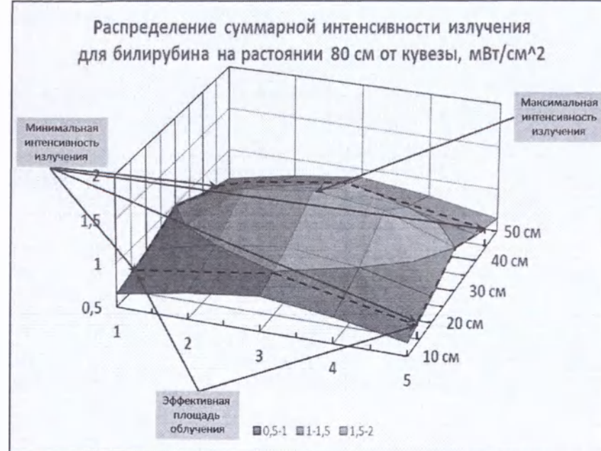
Рис.10. Распределение суммарной мощности облучения для билирубина на расстоянии 80 см. от кувезы
