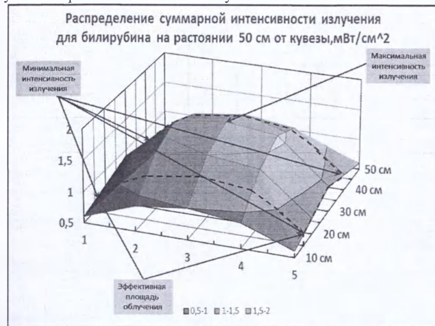
Рис.11. Распределение суммарной мощности облучения для билирубина на расстоянии 50 см. от кувезы
