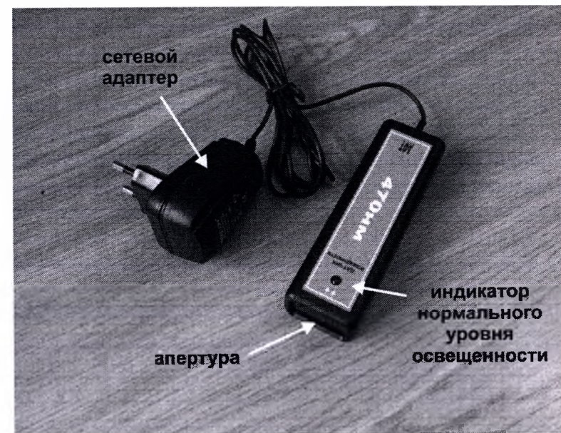
Рис.11. Датчик контроля светимости светодиодов
