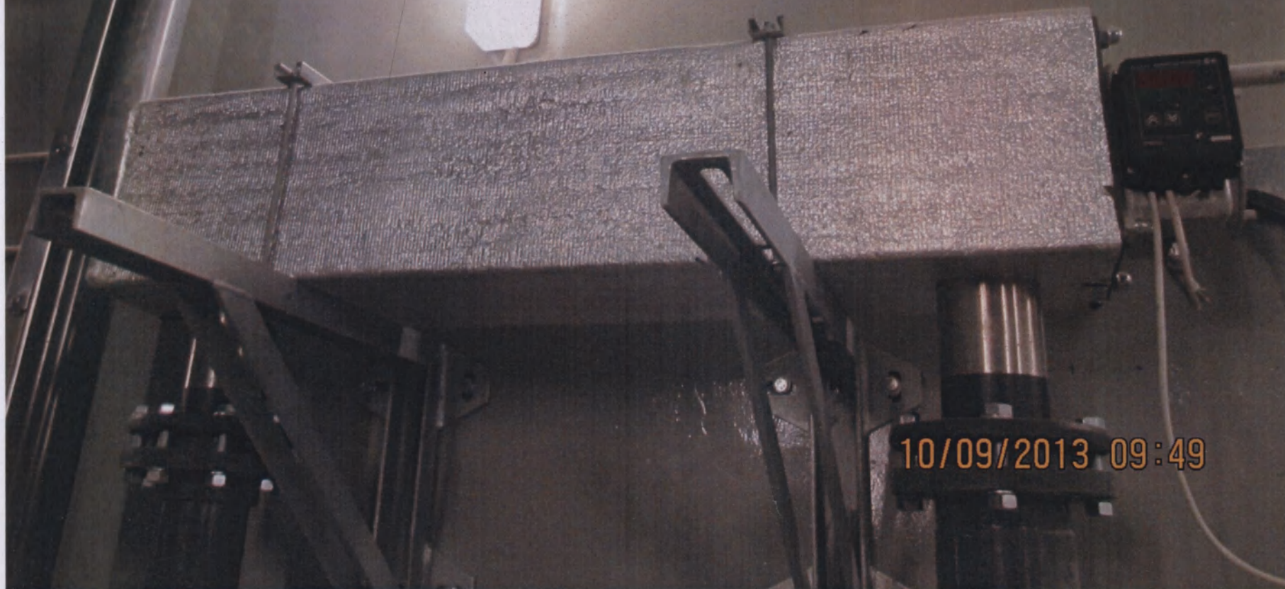
Блок осушки технологического воздуха (воздухонагреватель, с системой контроля температуры) - ООО «Электронагреватели», Россия
