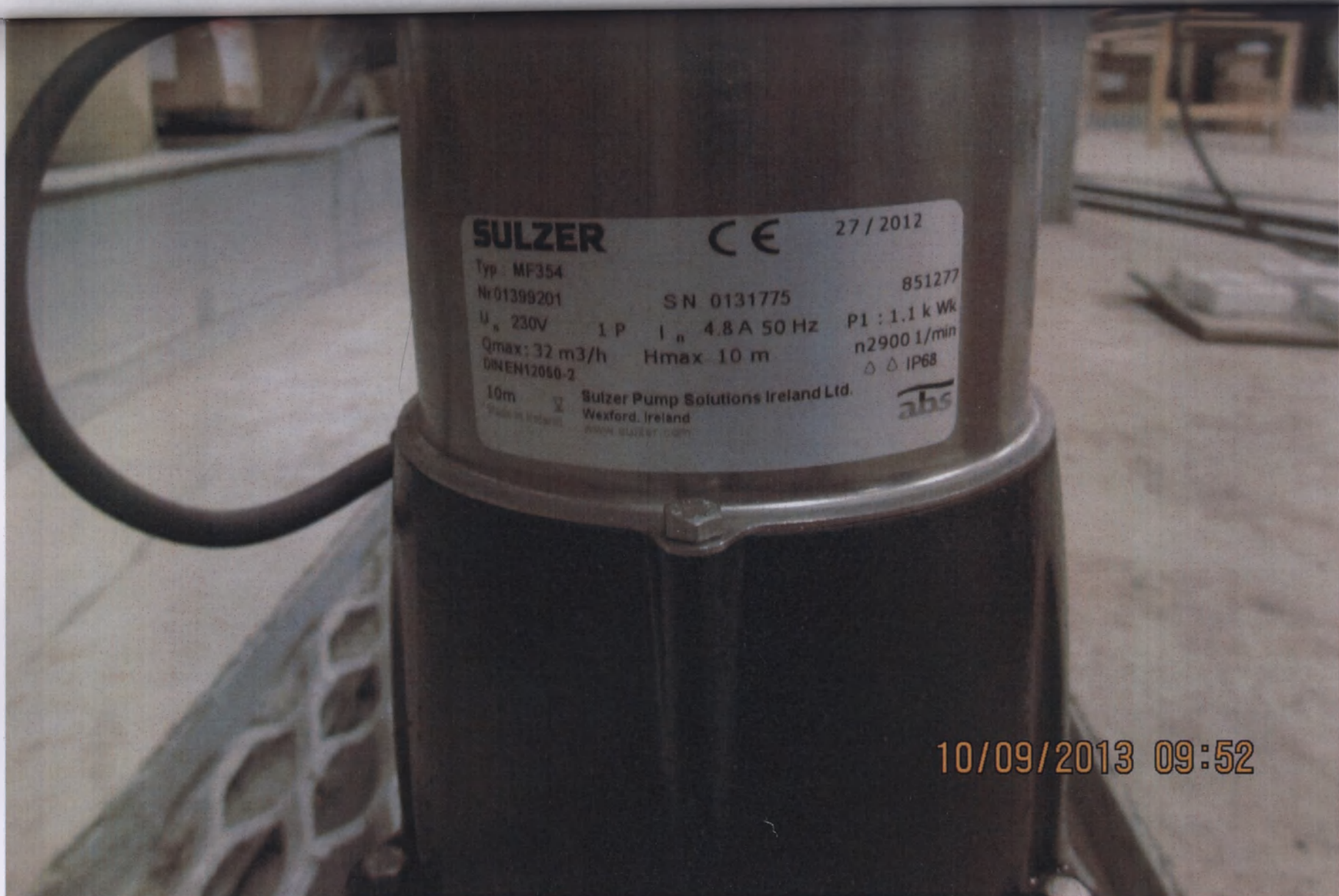
Дренажный насос для приямка - Компания «ABS», Германия
