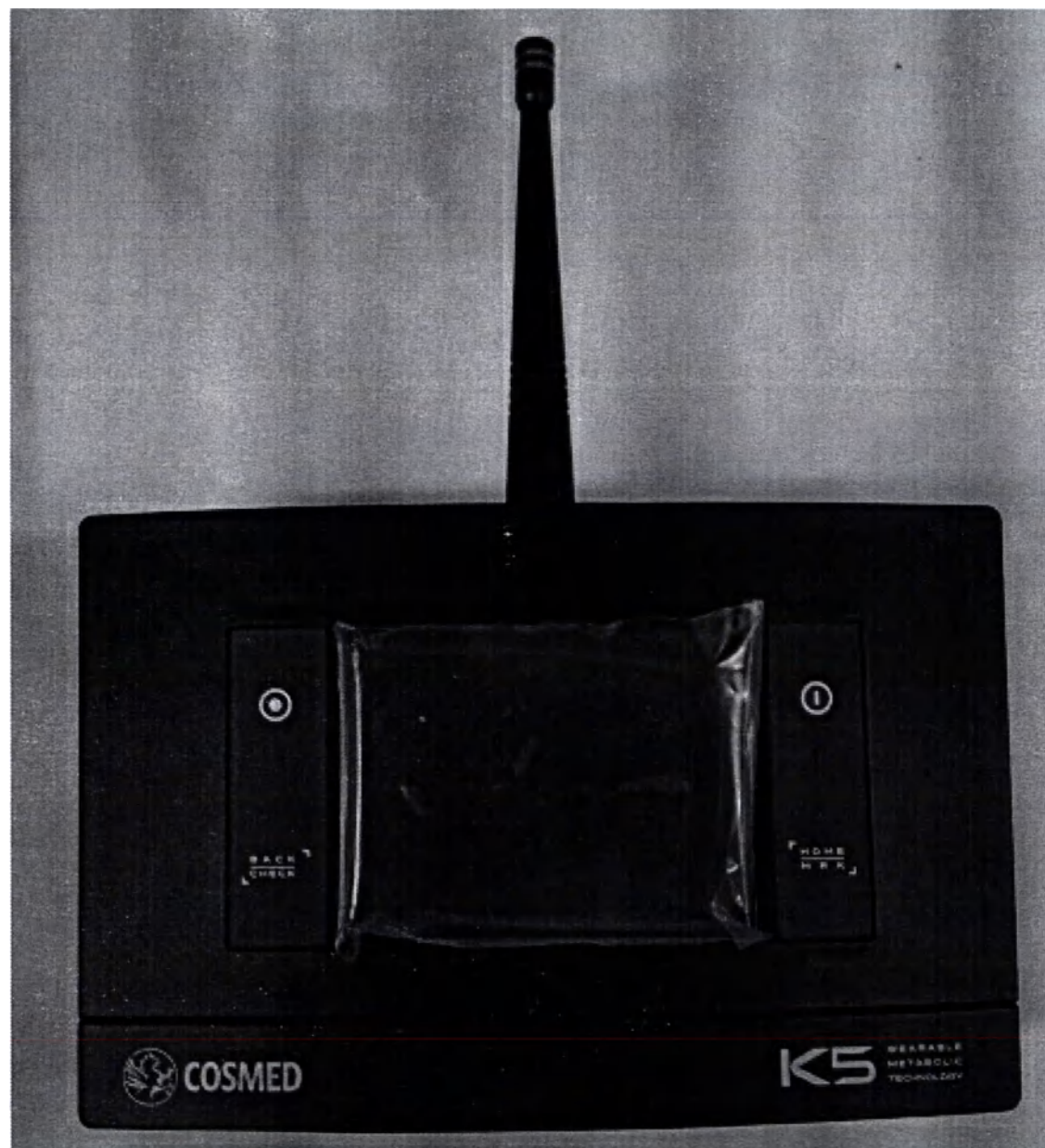
3.Антенна (поставляется при необходимости) (на фото показана Антенна, встроенная совместно с Блоком основным)
