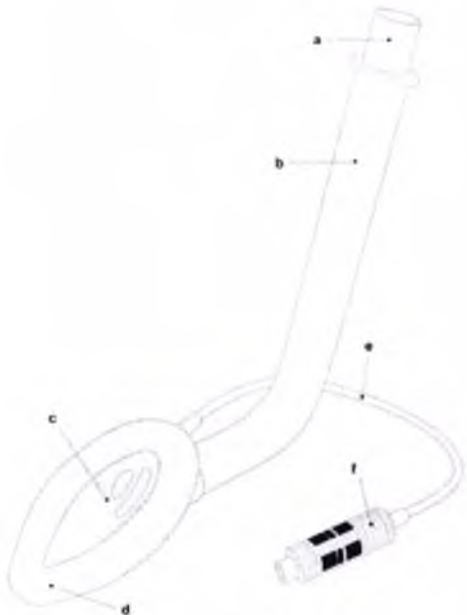
Рис. 2 Компоненты LMA Unique (Silicone Cuff) с датчиком манжеты: а) Коннектор; б) Дыхательная трубка; в) Задняя стенка; д) Манжета; е) Трубка для надувания манжеты; ф) Датчик манжеты (Cuff Pilot)
