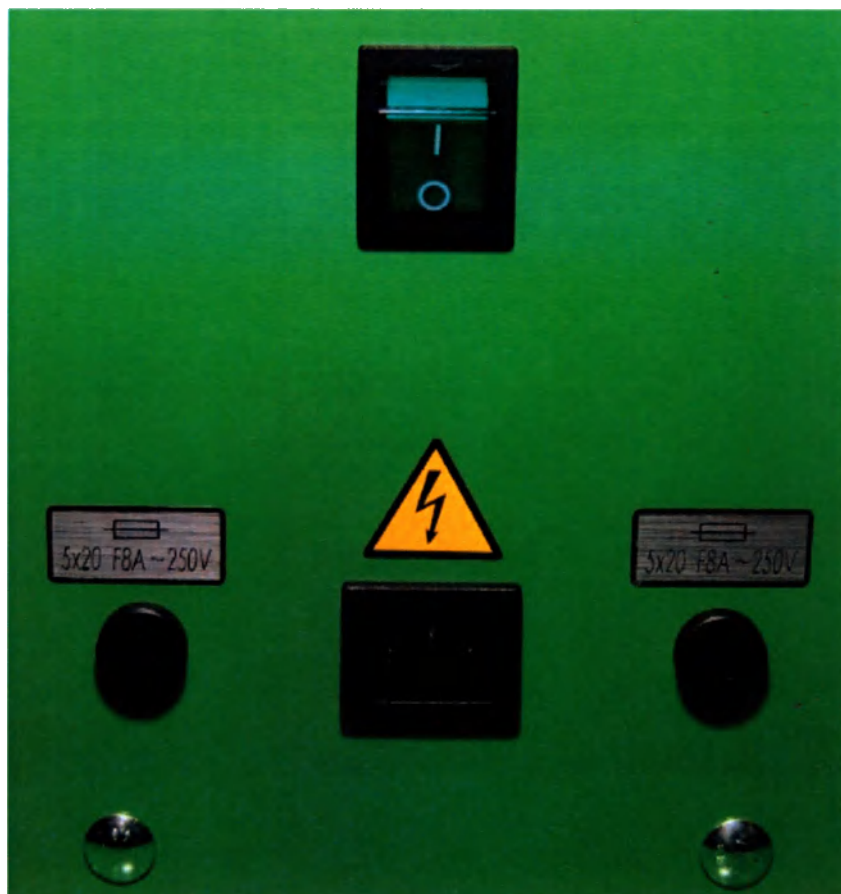
Рис. 6. Сетевой выключатель, гнездо питания, предохранители на задней панели тумбы.
