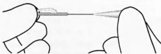
Рис. 6. Вытягивание обратно разреза втулки провода DPU
