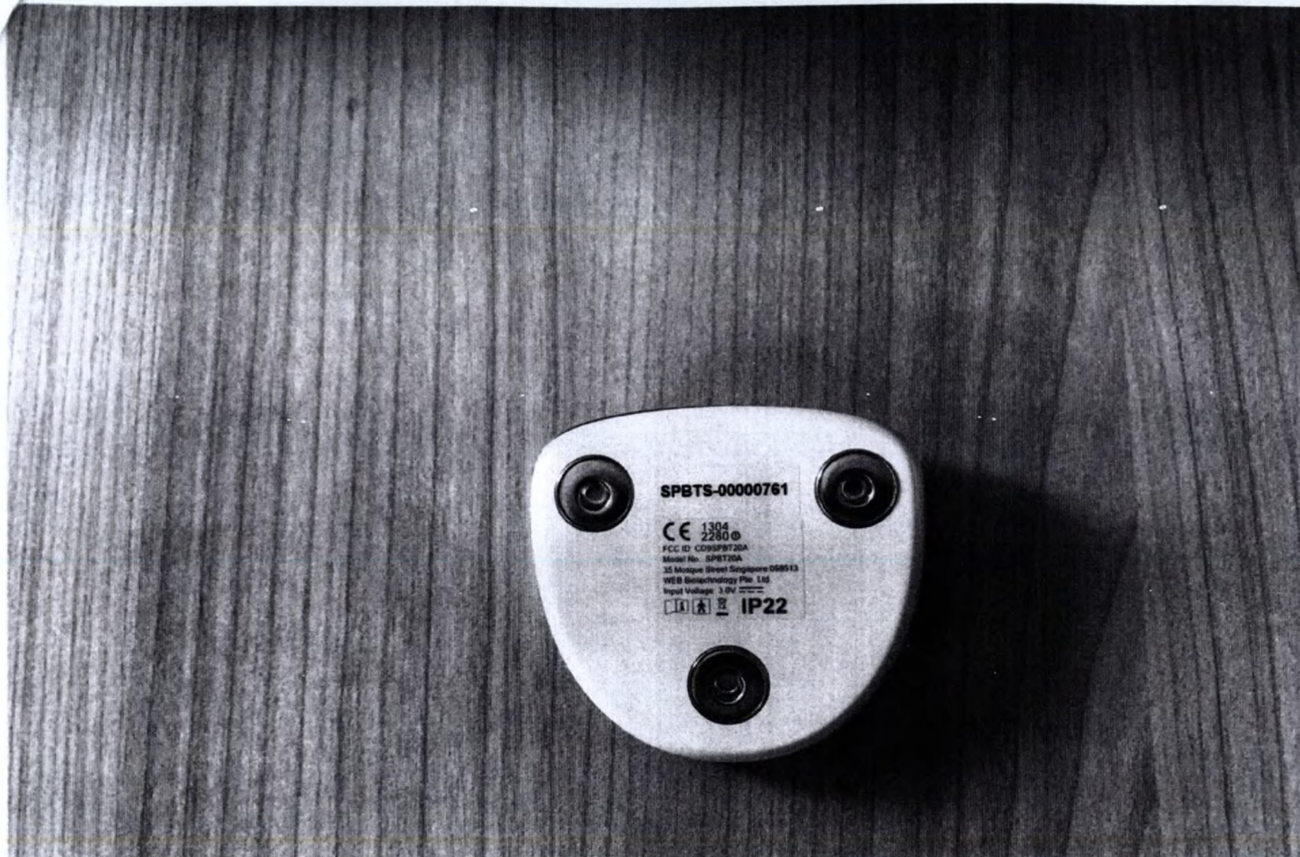
Фото 2 - Регистратор беспроводной Spyder Bluetooth для длительного онлайн мониторинга и анализа ЭКГ. (Вид снизу)
