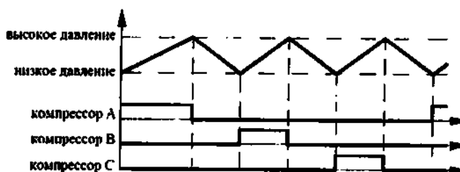
Рисунок 25 – Диаграмма работы винтовых компрессоров в режиме «Вкл./Выкл.»
