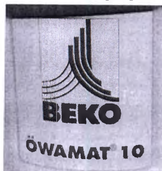
Рис. 39 – Пример дополнительной маркировки масляного сепаратора
