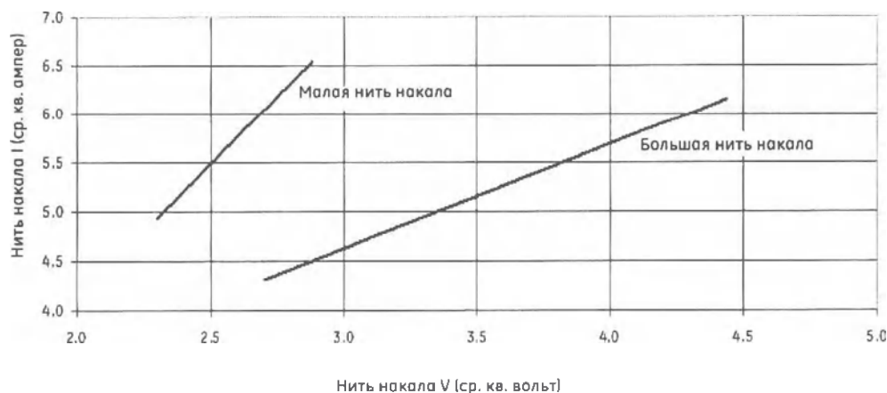
Рис. 15-8 Характеристики нити накала V-I
