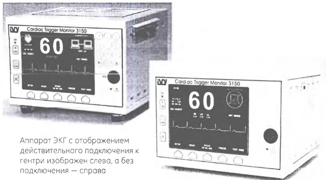
Рис. 36-13 Аппарат ЭКГ, отображающий подключение к гентри
