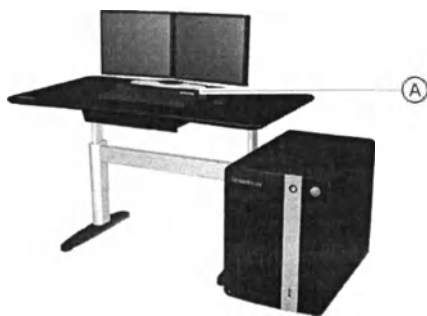
Пульт управления блока КТ системы D670
