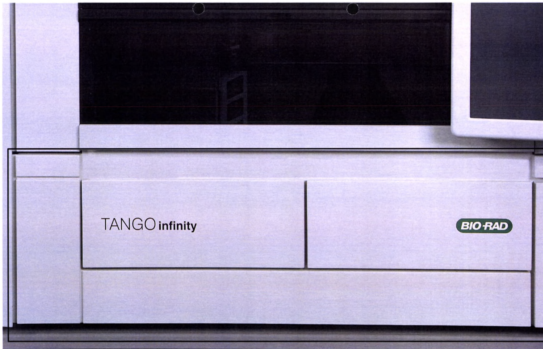
Модуль фронтальной крышки (дверь отсека образцов/реагентов) (Front Cover Module (Sample/Reagent Bay Door)) (выделен черным)
