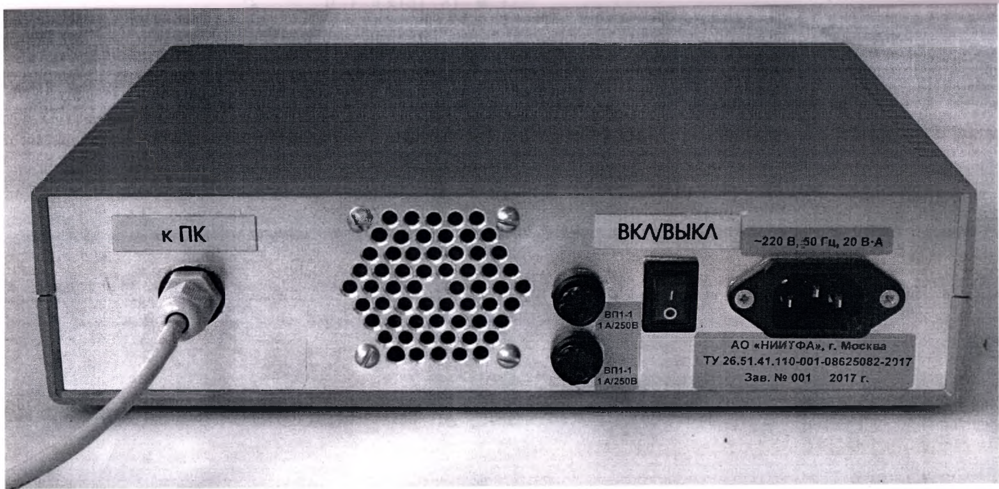
Фотографическое изображение блока регистрации и обработки информации. Задняя панель.
