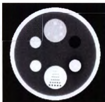
Слой стержней с использованием протокола проверки качества изображений головы Head STD-QA
