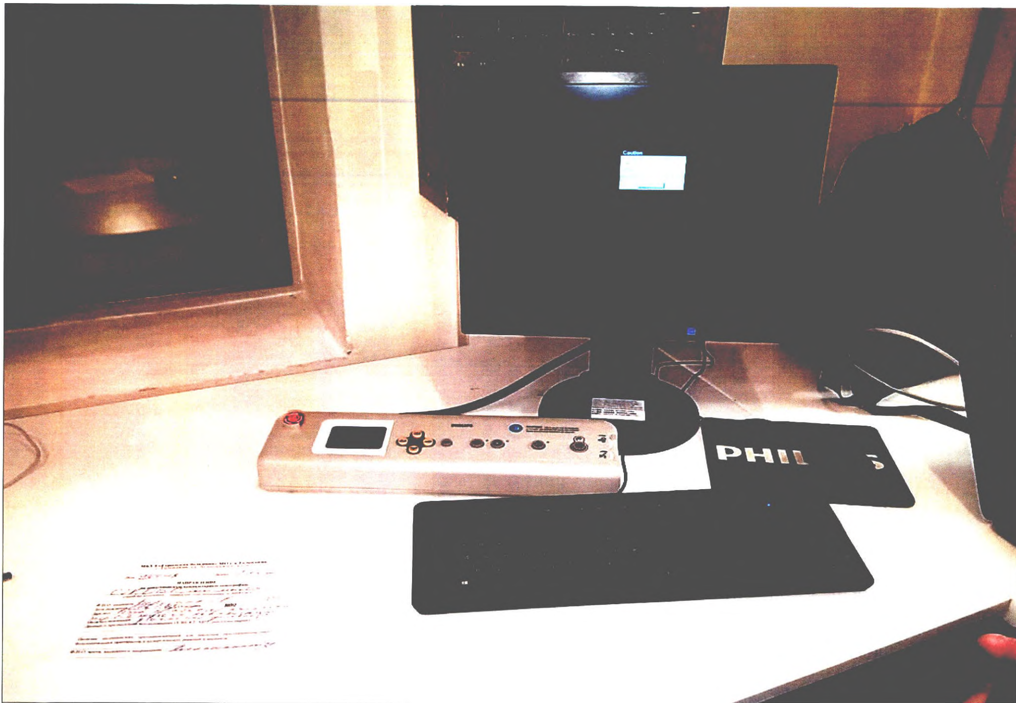
36. Рабочая станция для управления и наблюдения за процессом сканирования: вычислительная система; пульт управления сканированием; монитор; клавиатура; мышь; базовое программное обеспечение версии V2.0 и выше.
