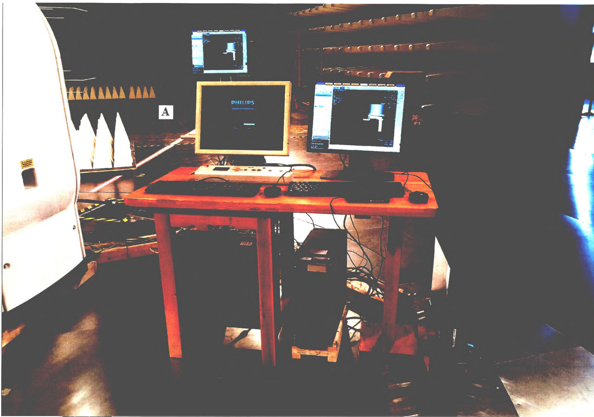
4а. Дополнительная рабочая станция EViewer для обработки изображений в составе: блок компьютерный, программное обеспечение EViewer, монитор, мышь, клавиатура, (на фотографическом изображении слева - А).
