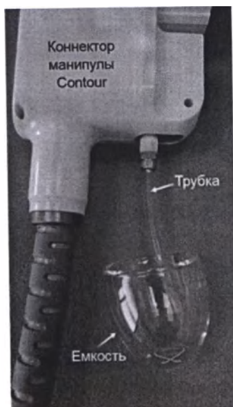
Рисунок 29. Подключение сливной трубки к коннектору манипулы Contour.
