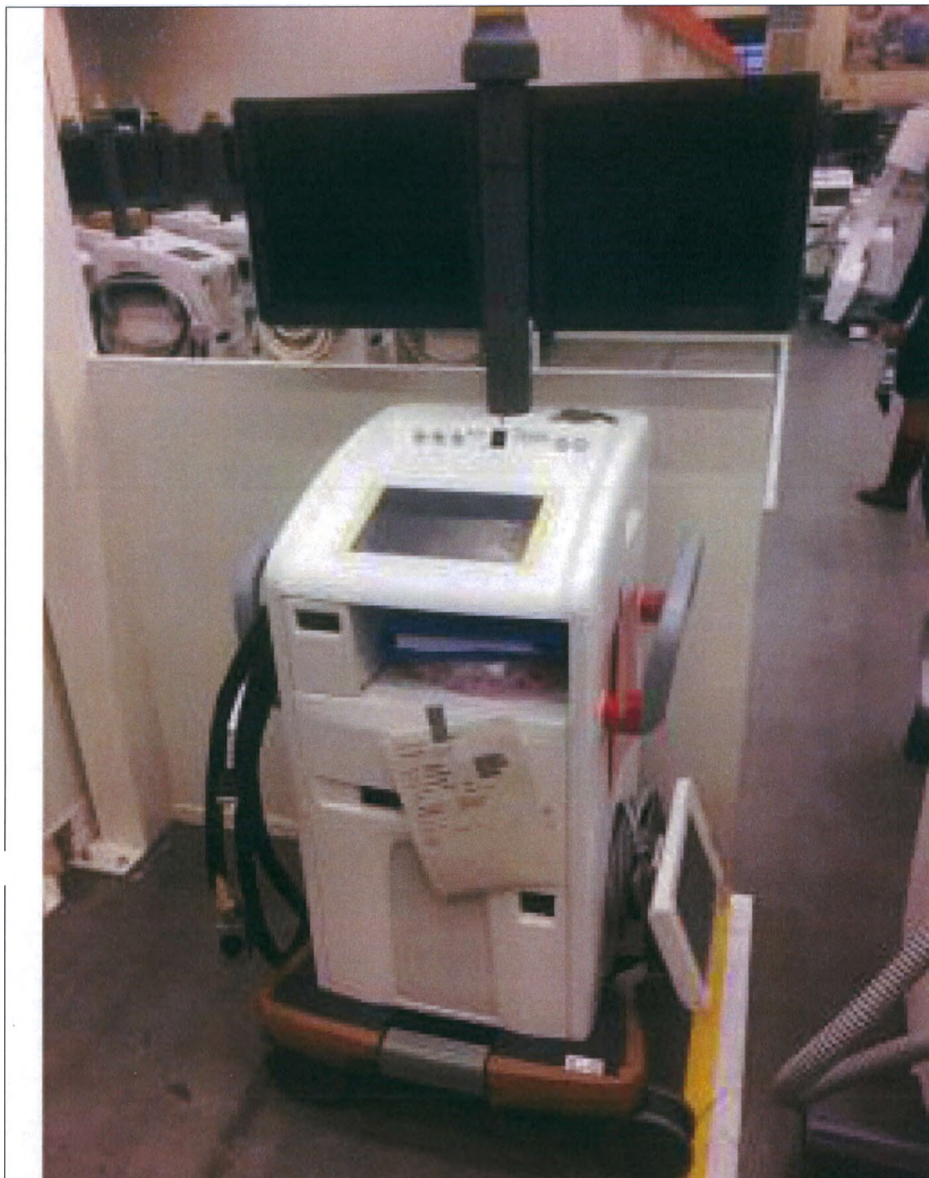
2.1 Мониторная стойка, в составе: штатив мониторов, варианты исполнения стойка дисплея Flex или стойка дисплея Flex Plus; панель управления с сенсорным экраном, мышь, порт USB, монитор, дисковод для дисков DVD.
