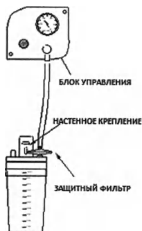
Флакон 1000 мл. с крышкой, клапаном переполнения/закрытия и угловым разъемом
