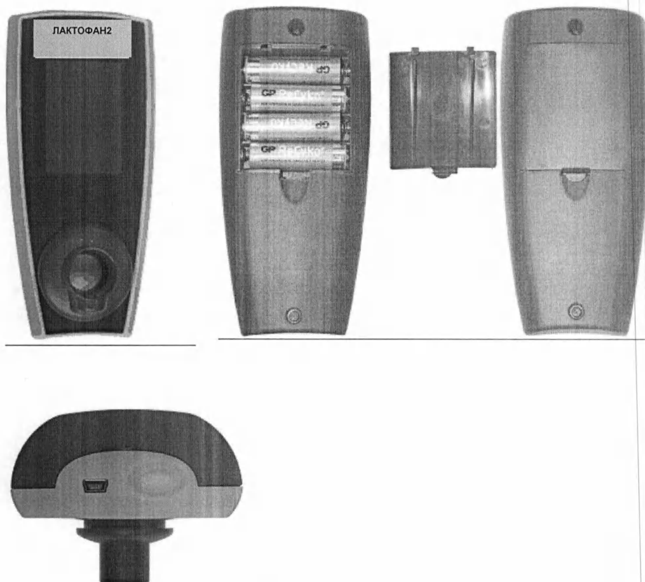
Рис. 2. Внешний вид анализатора ЛАКТОФАН2
