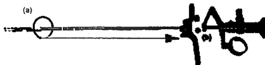
Рисунок 10: Установка электрода в направляющую трубку электрода
