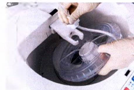
Рис. 28 Установка камеры отмывки
