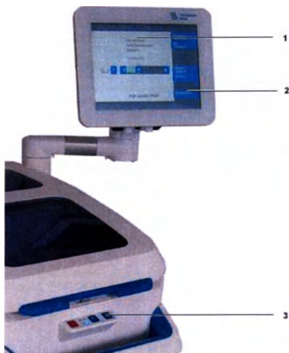
Рис. 7 Монитор и кнопки управления
