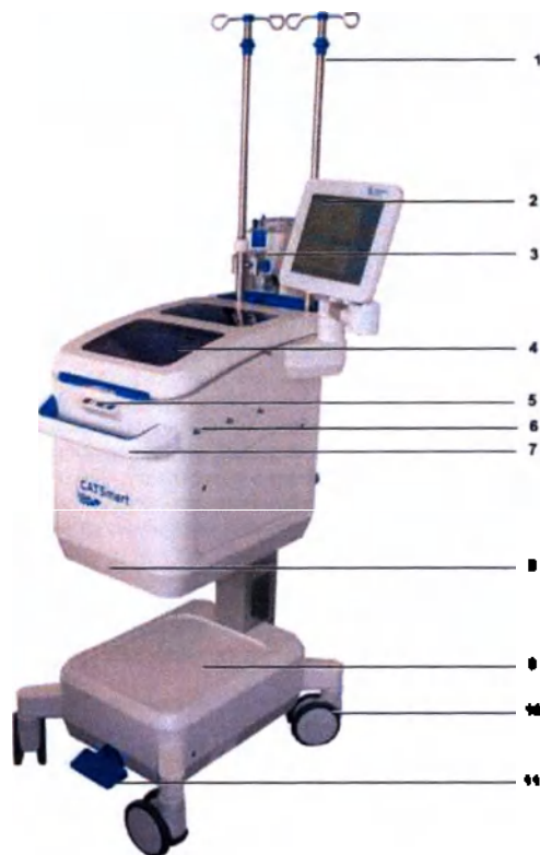
Рис. 5 Передняя сторона системы
