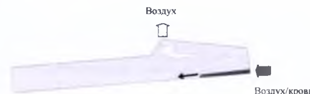
Рис. 15 Удаление воздуха из кровопроводящей магистрали
