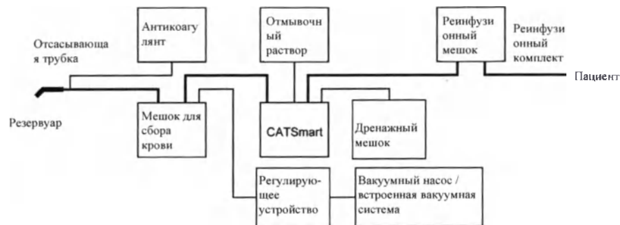
Рис. 1 Схема процесса аутоотрансфузии
