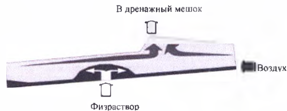
Рис. 16 Заполнение камеры отмывки
