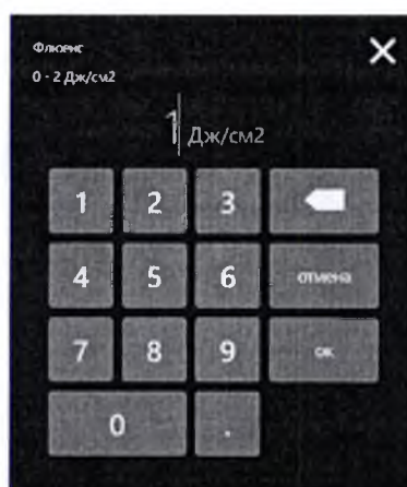
Рис. 5.35 – Настройка параметра «Энергия» с помощью числовой клавиатуры
