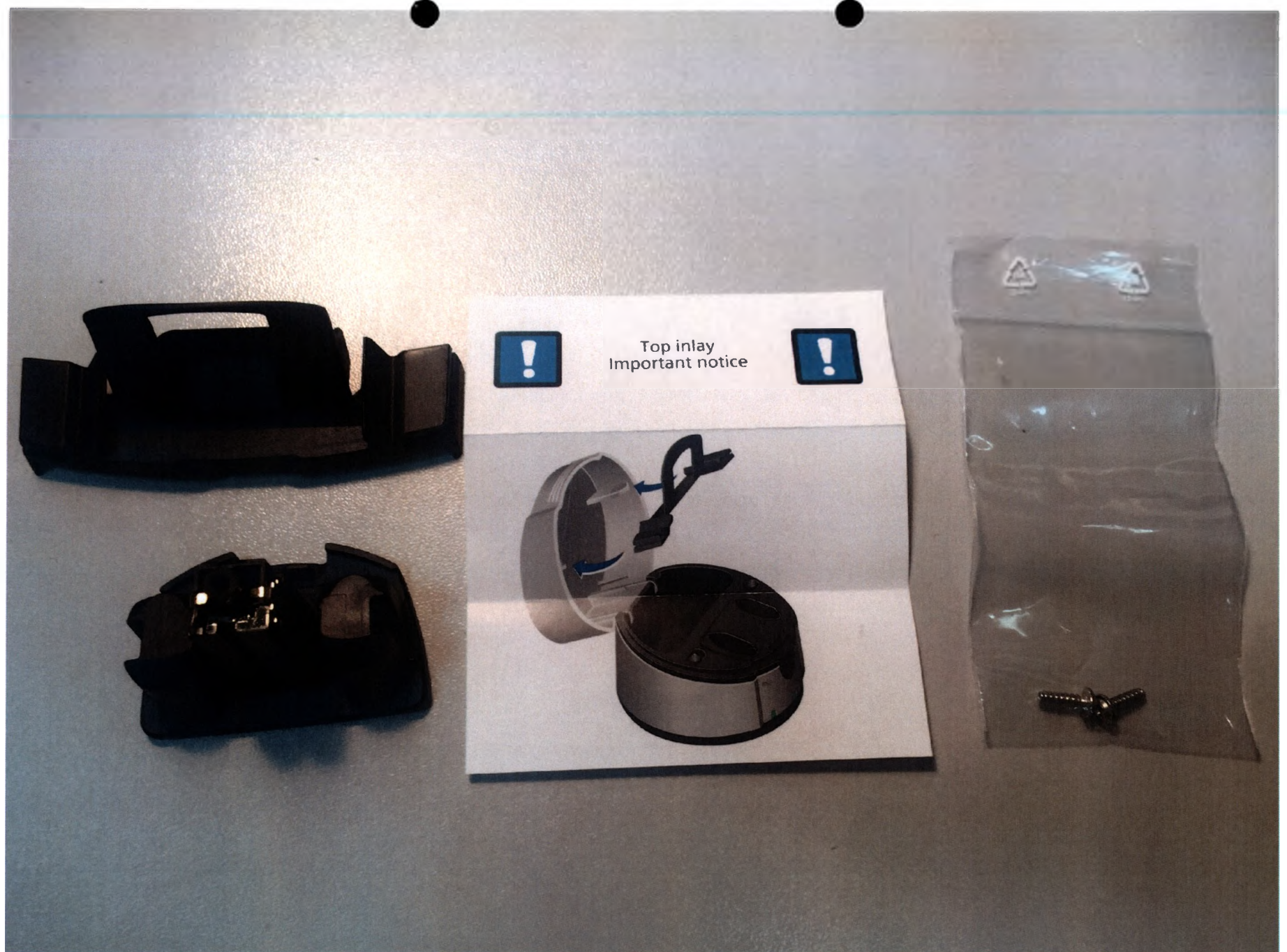
Вставки для зарядного устройства (Charger inlay 013-N) в комплекте: вставки – 2 шт., информационный вкладыш, шурупы – 2 шт.
