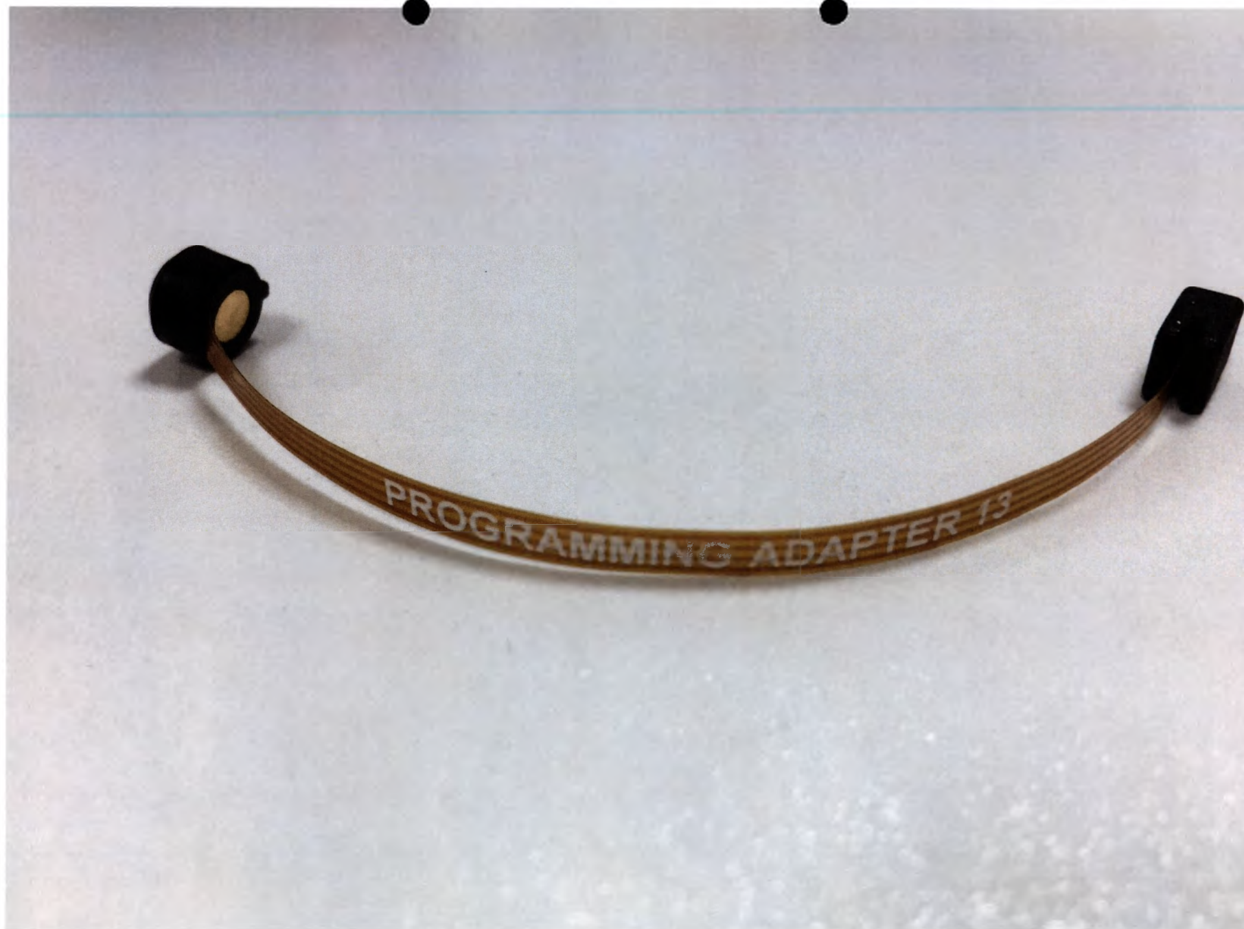
Адаптеры для программирования слуховых аппаратов, типоразмеры 10, 13, 312
