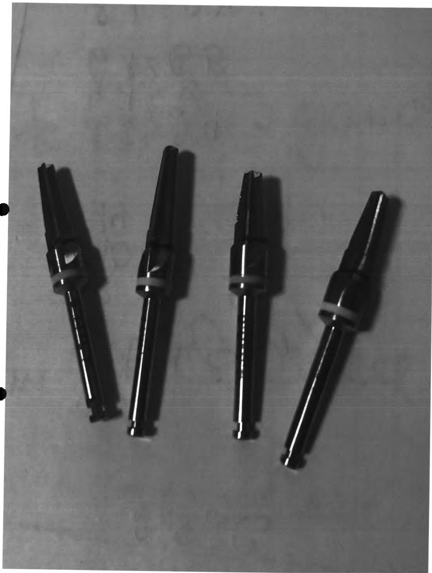
Рис.7. Коническая фреза с ограничителем: SF35-10, SF35-11, SF35-12, SF35-14, SF40-8,5, SF40-10, SF40-11,5, SF40-13, SF45-8,5, SF45-10, SF45-11,5, SF45-13, SF50-8,5, SF50-10, SF50-11,5, SF50-13, SF60-8,5, SF60-10, SF60-11,5, SF60-13.
