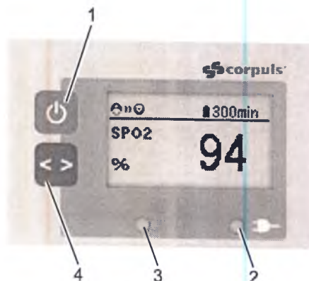
Рис. 4-6 Блок пациента, кнопки управления и светодиоды
