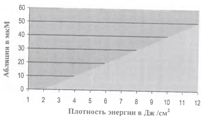
Рисунок 29: Глубина абляции в зависимости от плотности энергии
