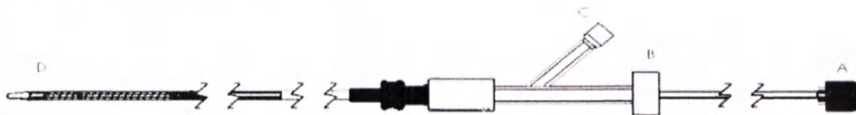
Рисунок 5 – Устройство системы доставки (А - внутренняя трубка с каналом для прохождения направляющего проводника, на конце трубки колпачок; В - гемостатический клапан Y коннектора; С - проход орошения Y коннектора (наружный диаметр Y коннектора составляет 9 Fr (3 мм)); D - внешняя трубка, покрывающая стент)
