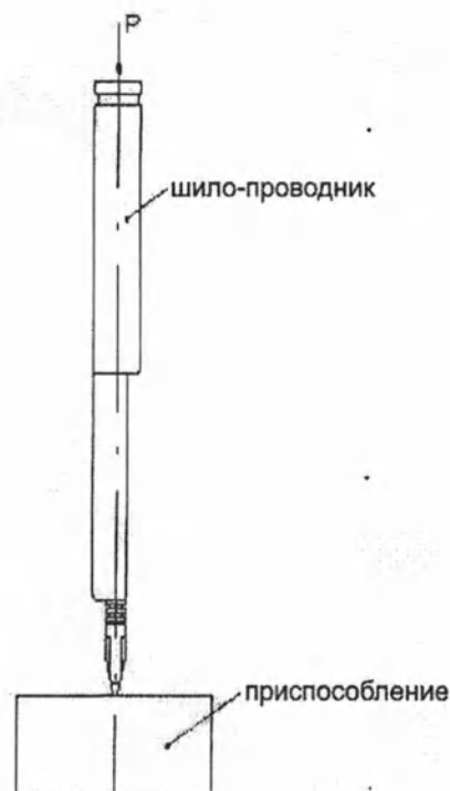
Рисунок Б6 – Схема приложения нагрузок к шило-проводнику
