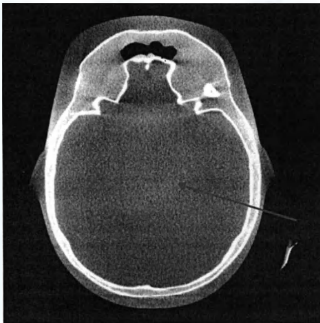
Рис. 7.16 Пример неоднородности в однородной области антропоморфного фантома. Существует несколько источников неоднородности, среди них: рассеянное излучение, увеличение твердости пучка, запаздывание и двоение.
