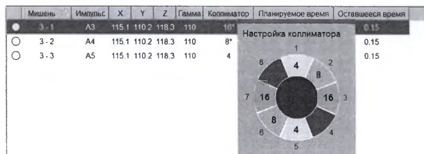
Рис. 6.17 Всплывающее изображение настройки коллиматора для конкретного импульса лечения
