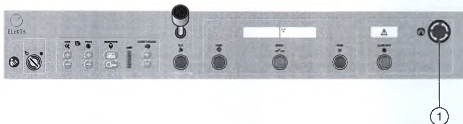
Рис. 5.74 Клавиша экстренной остановки на панели управления
