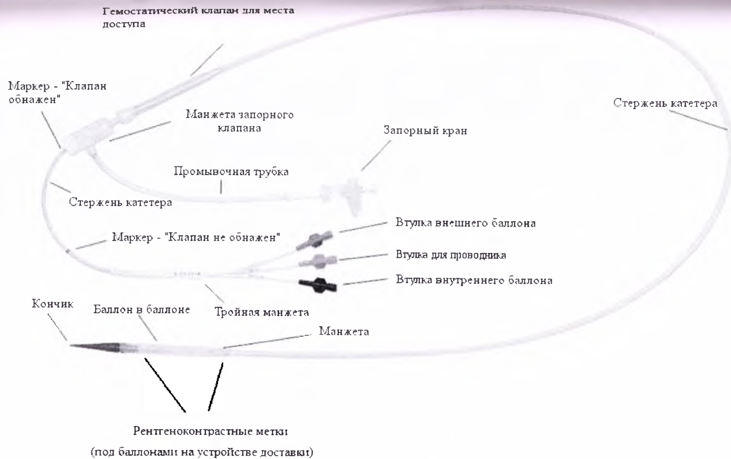
Рис. 9. основные функциональные части медицинского изделия
