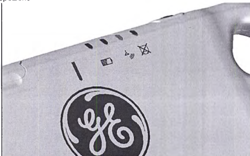
Рисунок 7-22 Батарея полностью разряжена; беспроводная связь подключена; облучение детектора не разрешено
