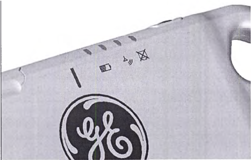
Рисунок 7-19 Осталось не менее 50 % заряда батареи; беспроводная связь подключена; детектор готов к работе
