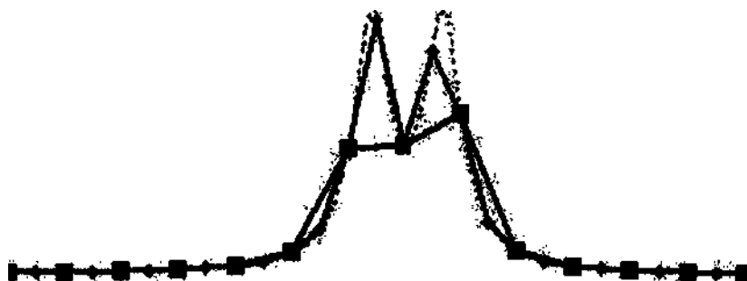
Рис. 331: Заполнение нулями приводит к интерполяции в частотной области. Черная линия — это спектр с двумя пиками с низким разрешением. Заполнение нулями данных для удвоения числа точек выявило два явных пика (серая линия). Серая пунктирная линия демонстрирует эффект сглаживания от дальнейшего заполнения нулями. Разрешение может быть значительно повышено, а спектр с заполнением нулями будет выглядеть лучше.
