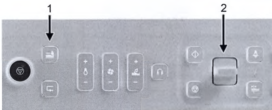
Рис. 2. Модуль пользовательского интерфейса (UIM). 1: Кнопка "Ручное управление", 2: Тумблер.
