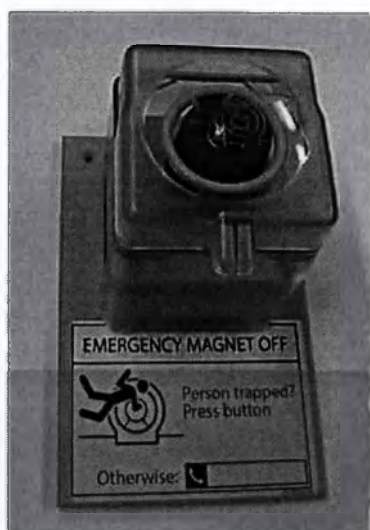
Рис. 2: Кнопка экстренного выключения магнита с соответствующей этикеткой.
