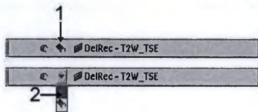
Рис. 269: Щёлкните по пиктограмме "Пауза, заданная пользователем", чтобы начать реконструкцию. 1. сперва щёлкните по пиктограмме, 2: затем щёлкните по пустому месту под стрелкой.
