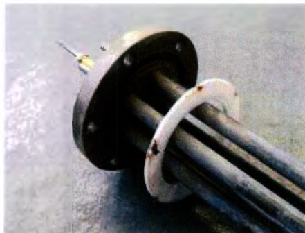
Рисунок 70 – Проверка и замена уплотнителя
