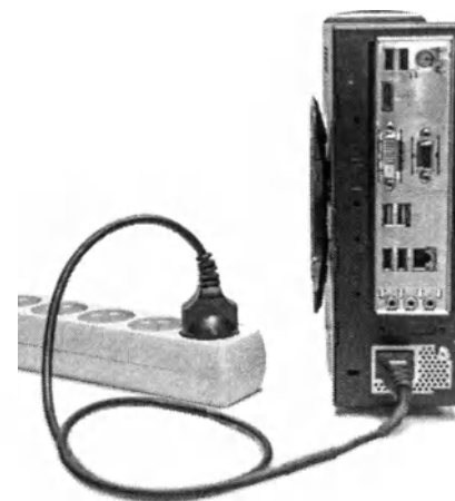
Рис. 7. Подключение сетевого фильтра
