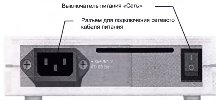
Рис. 4. Задняя панель блоков концентраторов «КМ-7», «КМ-7-2».
