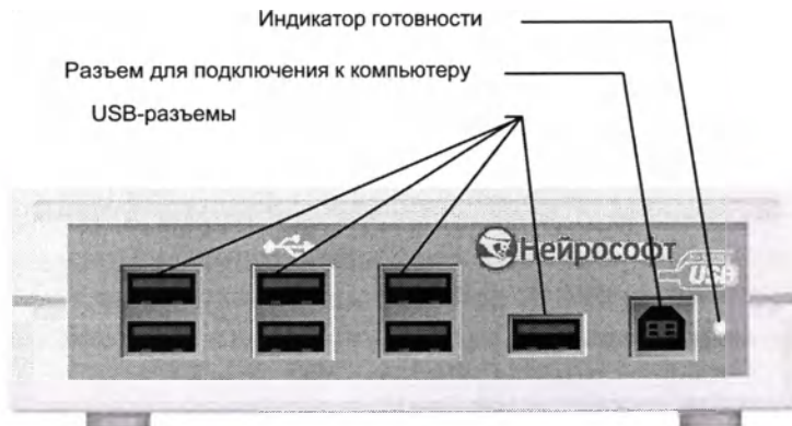
Рис. 3. Передняя панель блока концентратора «КМ-7-2».
