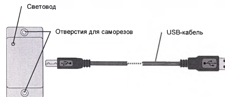
Рис. 1. Внешний вид датчика освещенности
