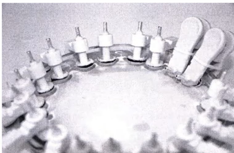
Рис. 17. Замачивание рабочих частей электродов
