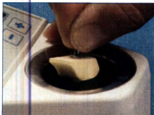
Рисунок № 3 Этап 3: погружение штампа
