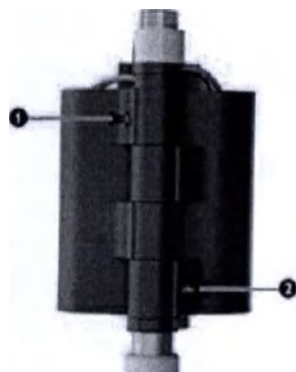
Рисунок 5.4 Мониторы: стопорные болты для транспортировки (1 и 2)
