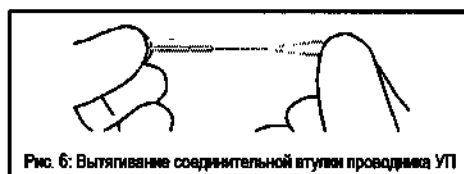
Рис. 6: Вытягивание соединительной втулки проводника УП
