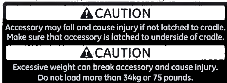
Рис. 2-32 Ограничение нагрузки на дополнительное оборудование
