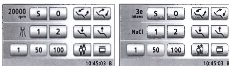
Диалог запуска в режиме EasyMode с функциями инструментов для режимов Мотор и Ультразвук (функция эндодонтии активна)
