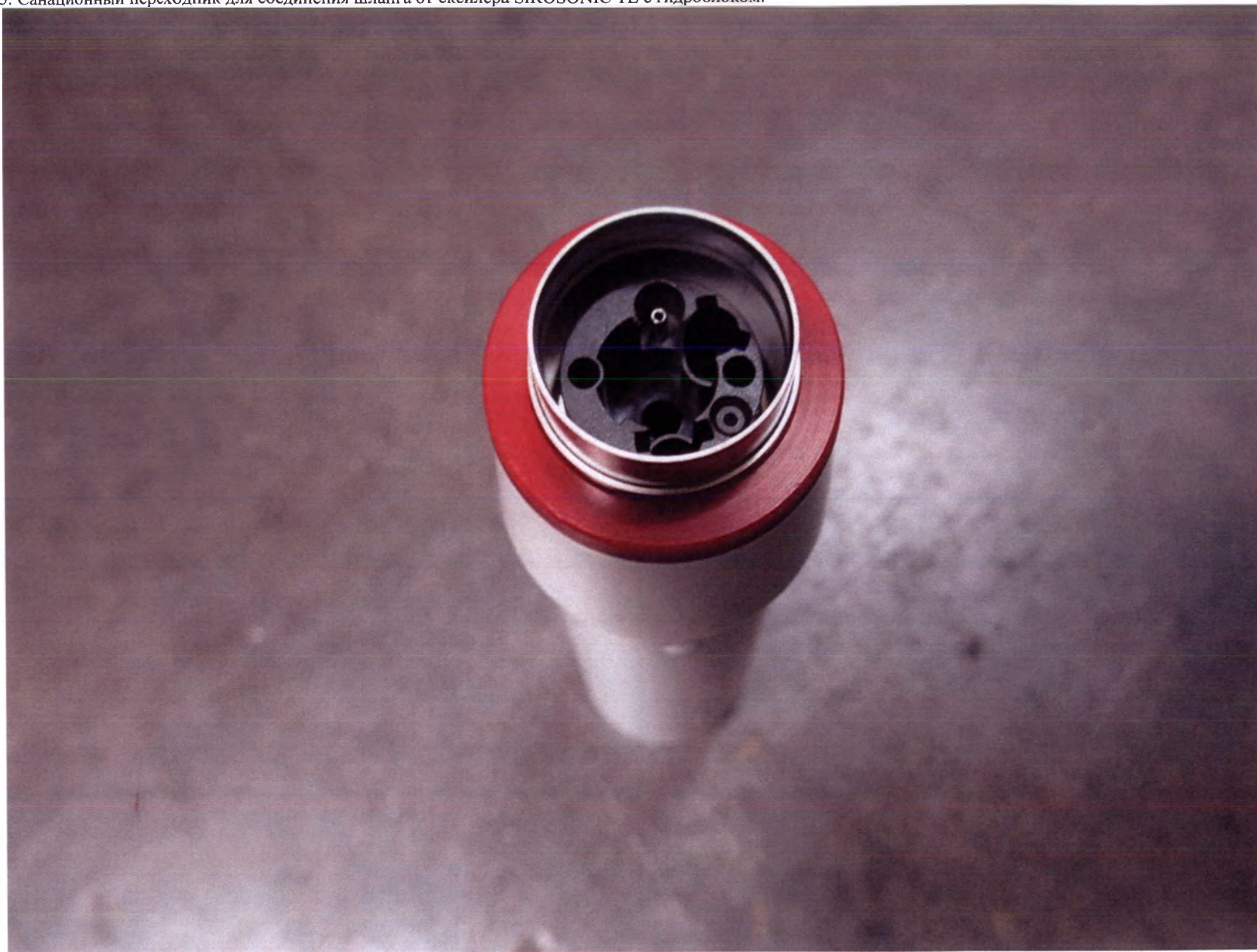
57.5. Санационный переходник для соединения шланга от скейлера SIROSONIC TL с гидроблоком.
