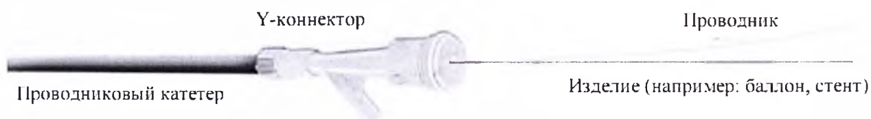
Рис. 3: Подсоединение Y-коннектора с другими изделиями
