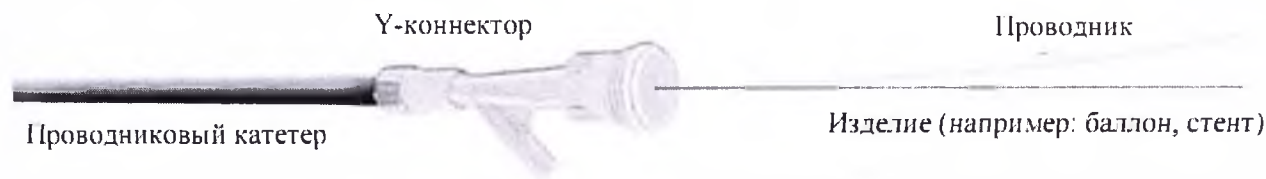
Рис. 2: Подсоединение Y-коннектора с другими изделиями
