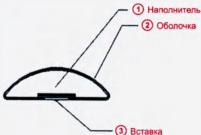
Чертеж продукта гладкого типа в разрезе
