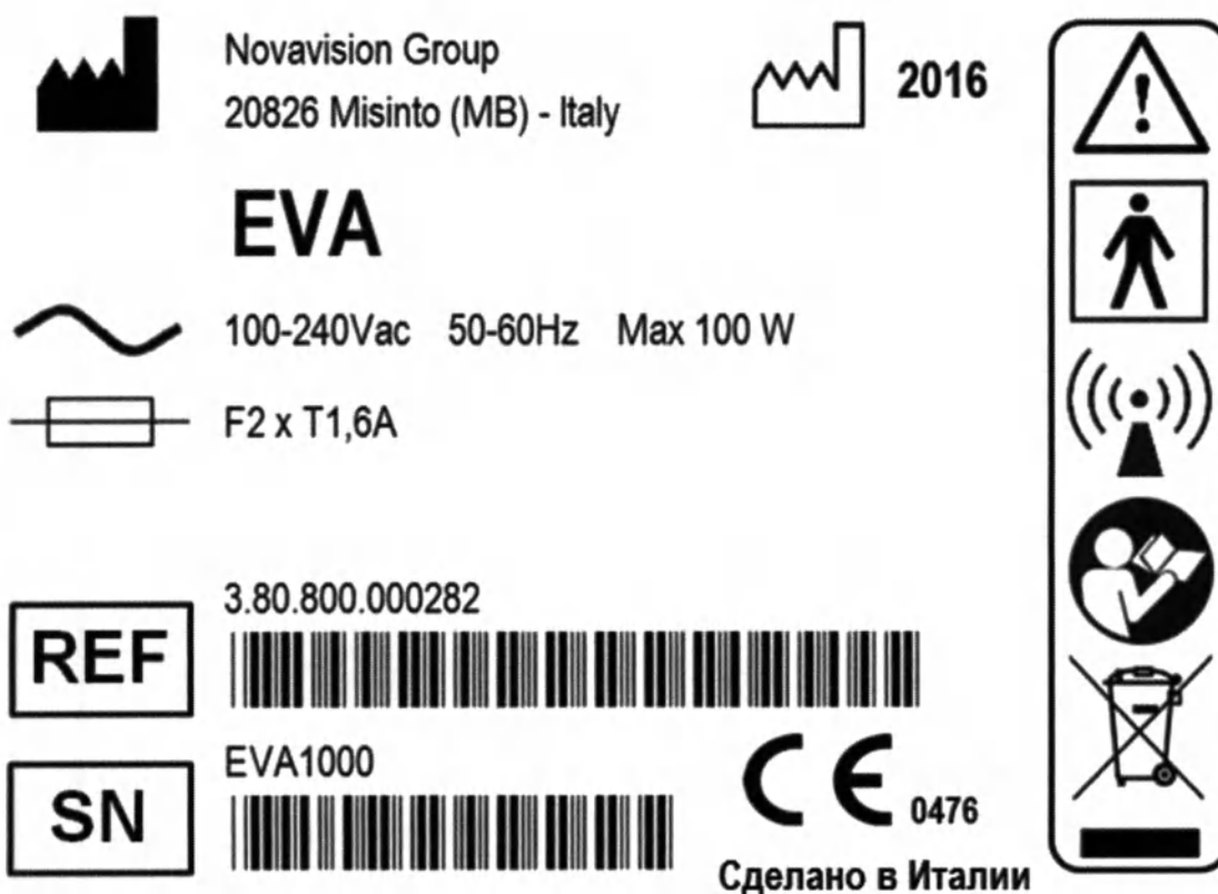
Рисунок 8. Макет маркировки радиочастотного устройства EVA для лечения послеродового растяжения мышц влагалища.
