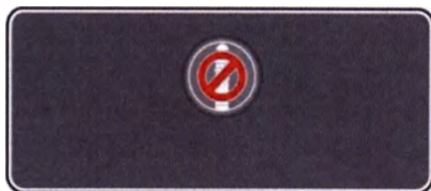
Изображение для подключенной рукоятки и неподключенного наконечника
