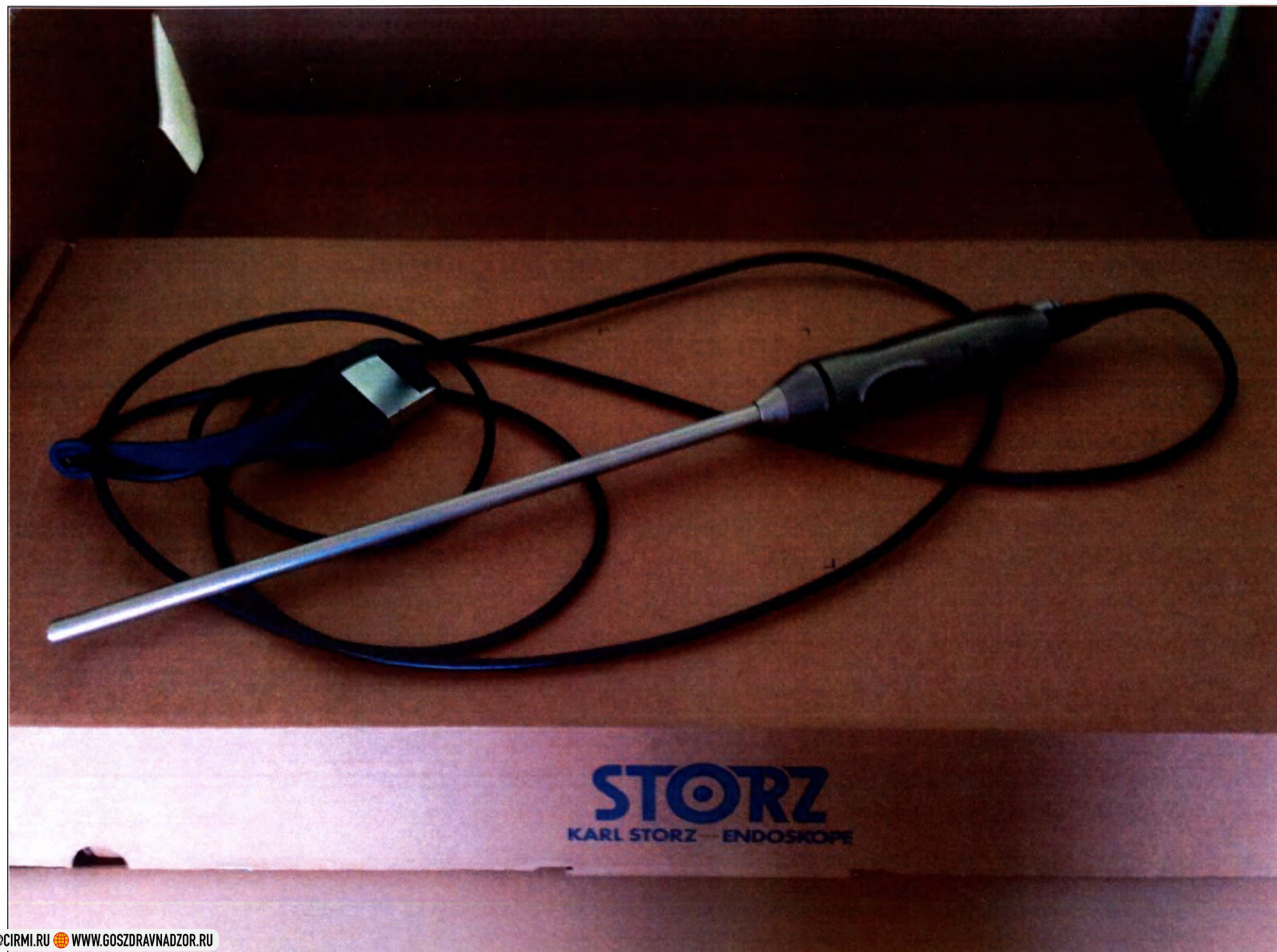
2. Видеолапароскоп высокого разрешения TIPCAM I S 3D с двумя дистально интегрированными видеочипами, угол обзора 30°
