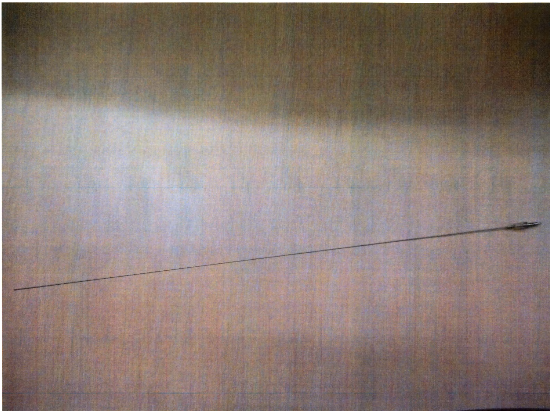
Зонд сплошной Ø 1,0 мм, длина 575 мм, рабочая длина 575 мм
