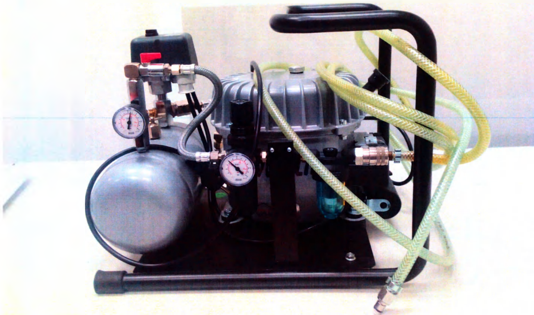
Воздушный компрессор, 230 В, 50/60 Гц с тканевым шлангом для подсоединения
